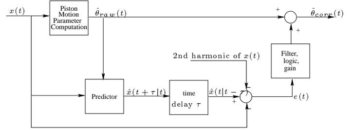
Fig. 9. Structure of piston motion parameter estimator.
