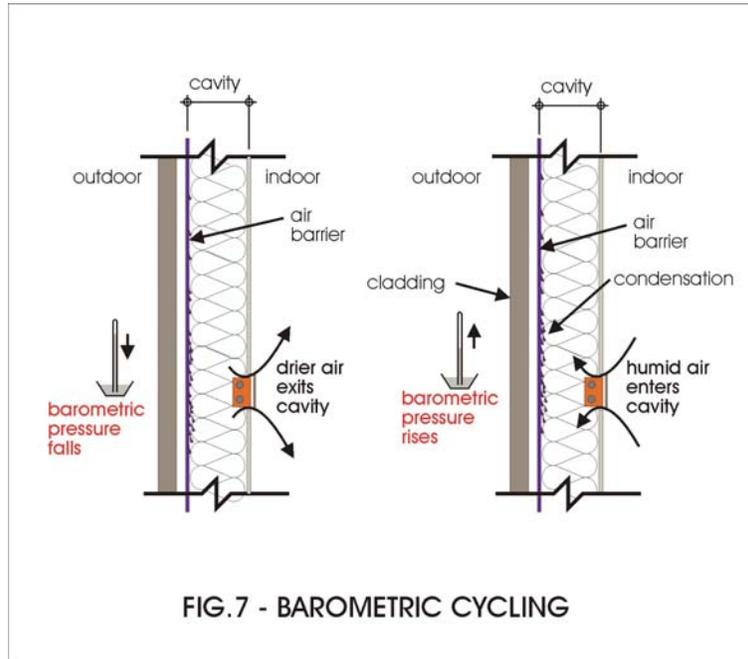
FIG.7 - BAROMETRIC CYCLING
