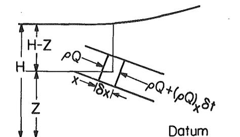
Fig. 1 Fluid element in a conduit
