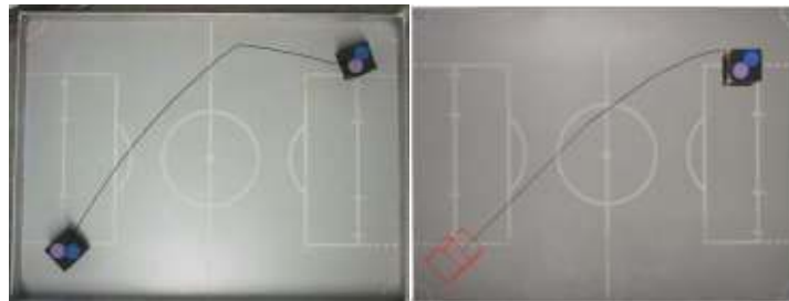
Figura 3. Deslocamento realizado pelo robô no ambiente real (à esquerda) e no virtual (à direita).
