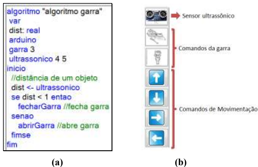
Figura 3. (a) Exemplo de algoritmo em ArduAlg utilizando garra e sensor ultrassônico. (b) Barra de comandos específicos.
