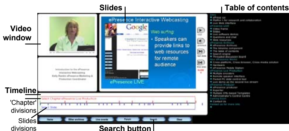
FIG. 3.4: Interface de navigation au sein de "webcasts" de présentations diapositives/vidéo comme proposée par Dufour et al. (2005) : on y voit une ligne temporelle représentant la chronologie entre les différentes diapositives et une table des matières construite dynamiquement.
