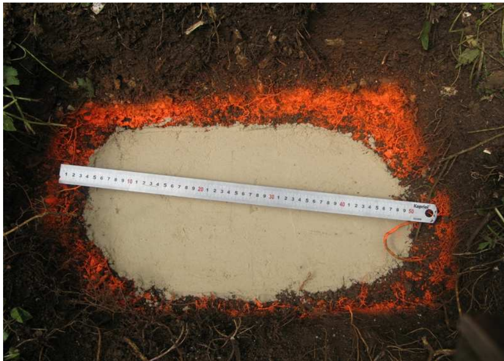
Figure 62. Le trou de l'essai de mesure du volume apparent au sable : après décapage du sol organique, marquage avant l'excavation (en haut), après l'excavation et le remplissage avec du sable à jager (en bas).
