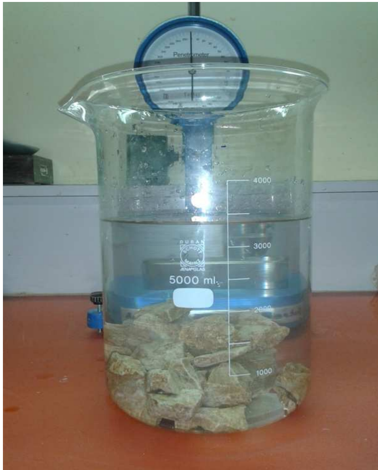
Figure 63. Détermination du volume des cailloux dans l'eau.
