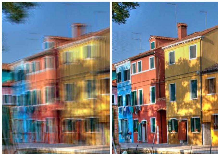
**Figure 1** – A gauche: une image floue (et bruitée) acquise par une caméra *flutter shutter* numérique. Le flou a un support de 52 pixels. A droite: l'image déconvoluée. Ces images ont été produites par un simulateur (publié [128]). Il simule l'image acquise à partir de l'émission (Poisson) de photons. Une telle déconvolution n'est pas possible sans utiliser une caméra *flutter shutter*.
