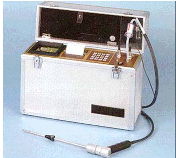
Rys. 3. Widok ogólny zastosowanego do pomiarów analizatora spalin IMR 3000 P [4]
