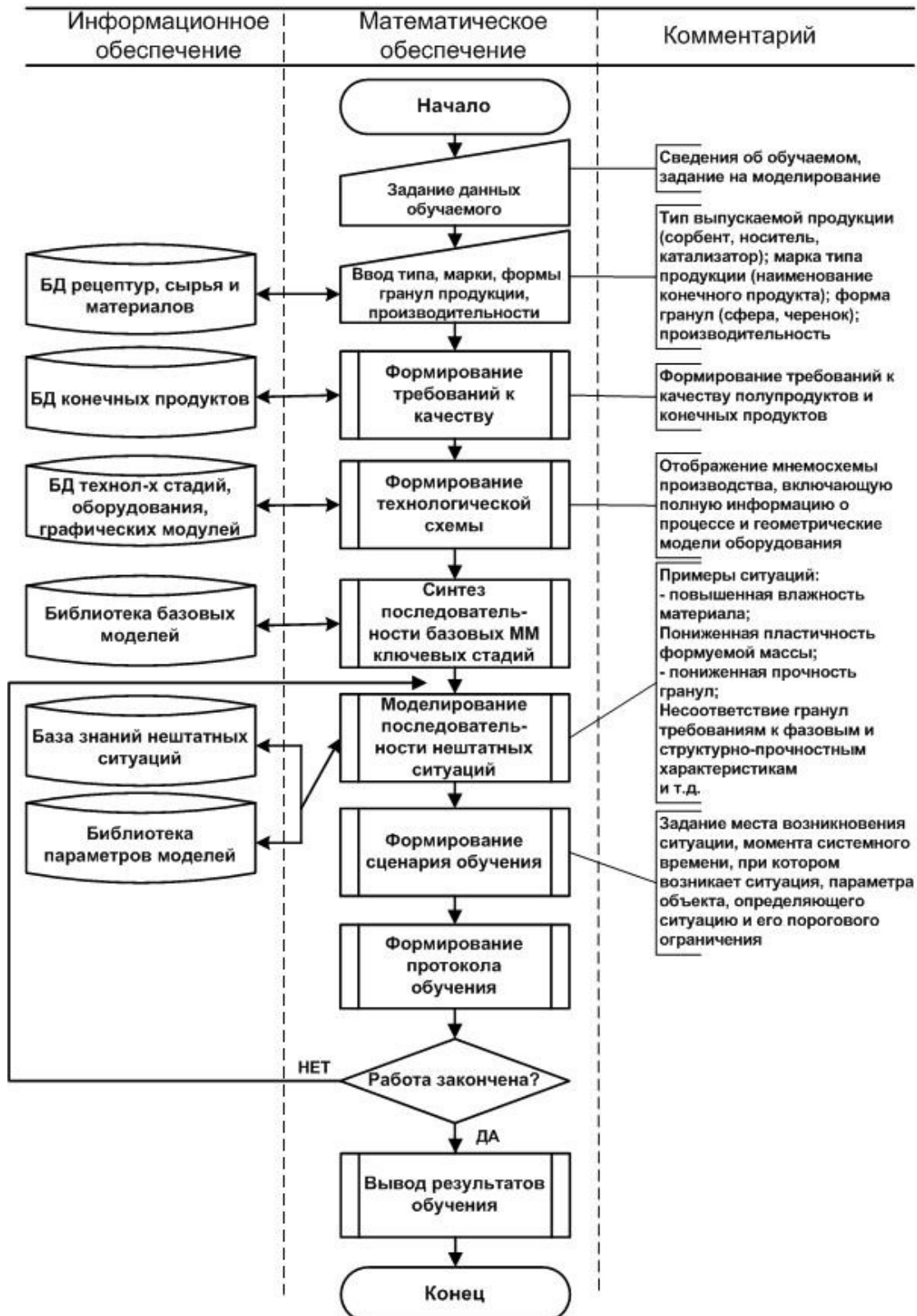
Рис. 2. Алгоритм синтеза системы имитационного моделирования для обучения управлению гибким многоассортиментным производством гранулированных пористых материалов
