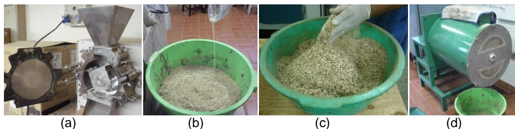
Figura 1. (a) Moinho de facas, (b) adição de resina, (c) homogeneização manual, (d) homogeneização mecânica por 5 minutos em misturador de tambor.
