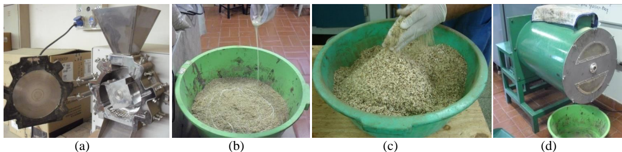
Figura 1. (a) moinho de facas, (b) adição de uma parte de resina, (c) homogeneização manual, (d) homogeneização mecânica por 5 minutos em misturador de tambor.
