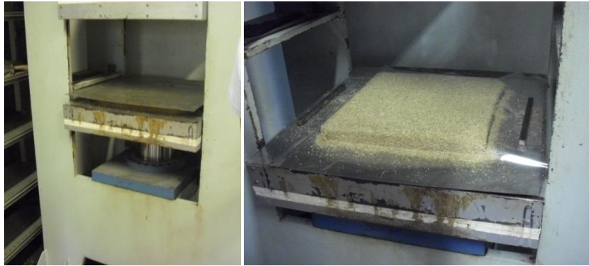
Figura 15 - Prensagem dos painéis. (a) Equipamento no momento de aplicação da pressão e (b) Momento de alívio de pressão
