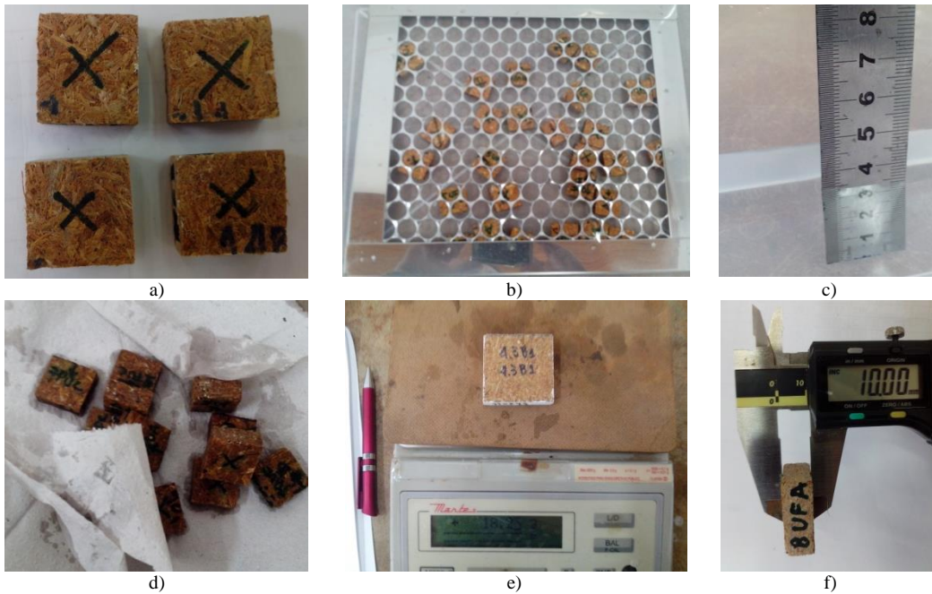
Figura 17 - Ilustrações do ensaio de inchamento e absorção (a) Corpo de prova esquadrejado (25mmx25mm); (b) Grelha em aço inox para manter o corpo de prova submerso; (c) Nível de água com cerca de 25 mm acima da superfície da amostra; (d) Remoção do excesso de água nos cps; (e) Pesagem; e (f) Medição da espessura com paquímetro
