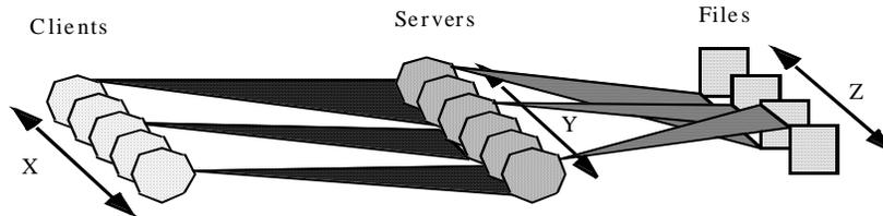
Figure 10. Server-Process-per-Client ( $X*Y*Z$  connections)
