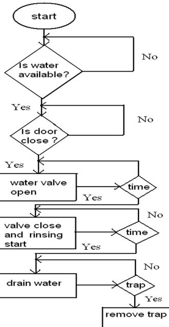
Fig. 3. Flowchart of rinsing module
