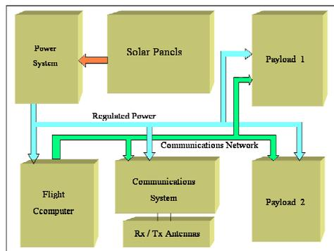
Fig. 1. Block diagram of NS subsystems
