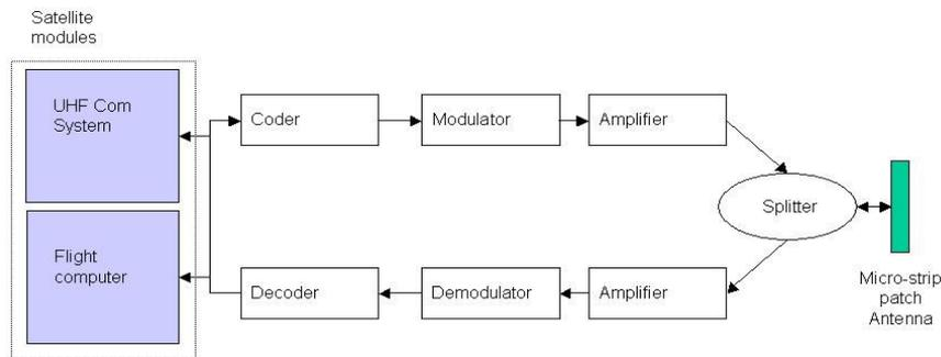
Fig. 3 Block diagram of NS subsystems
