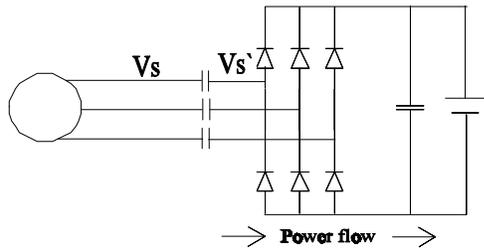
FIGURE 11. PHYSICAL DIAGRAM OF THE SERIES CAPACITOR COMPENSATION
