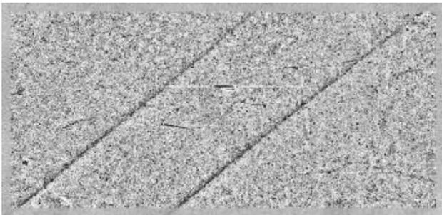
FIGURE 14. ENHANCED IMAGE OF SR-71 SHOCK WAVES FROM FIGURE 5
