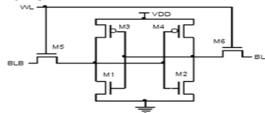
Figure1. 6T-CMOS SRAM Cell [4].
