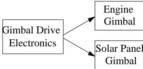
Figure 9: Interacting gimbal subsystems in DS1.
