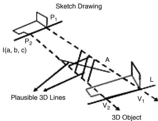
Fig. 7. Edge constraint.
