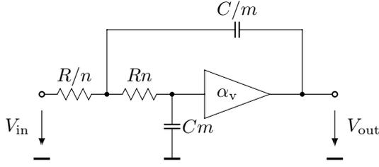
Fig. 1. A voltage-mode low-pass SAB.
